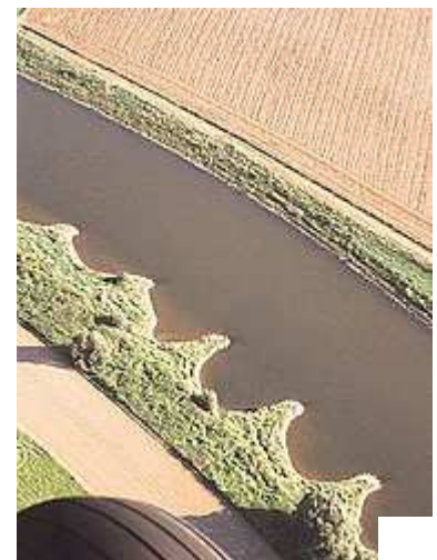
An den Bühnenköpfen erhöht sich die Fließgeschwindigkeit besonders stark.
